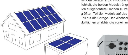
Mit den Geräten H3A, H4A und H5A haben Sie die Möglichkeit, die beiden Modulstränge auf zwei unterschiedlich ausgerichtete Flächen zu verteilen. Zum Beispiel den größten Teil der Module auf das Hausdach, den kleineren Teil auf die Garage. Der Wechselrichter regelt beide Modulflächen unabhängig voneinander.
