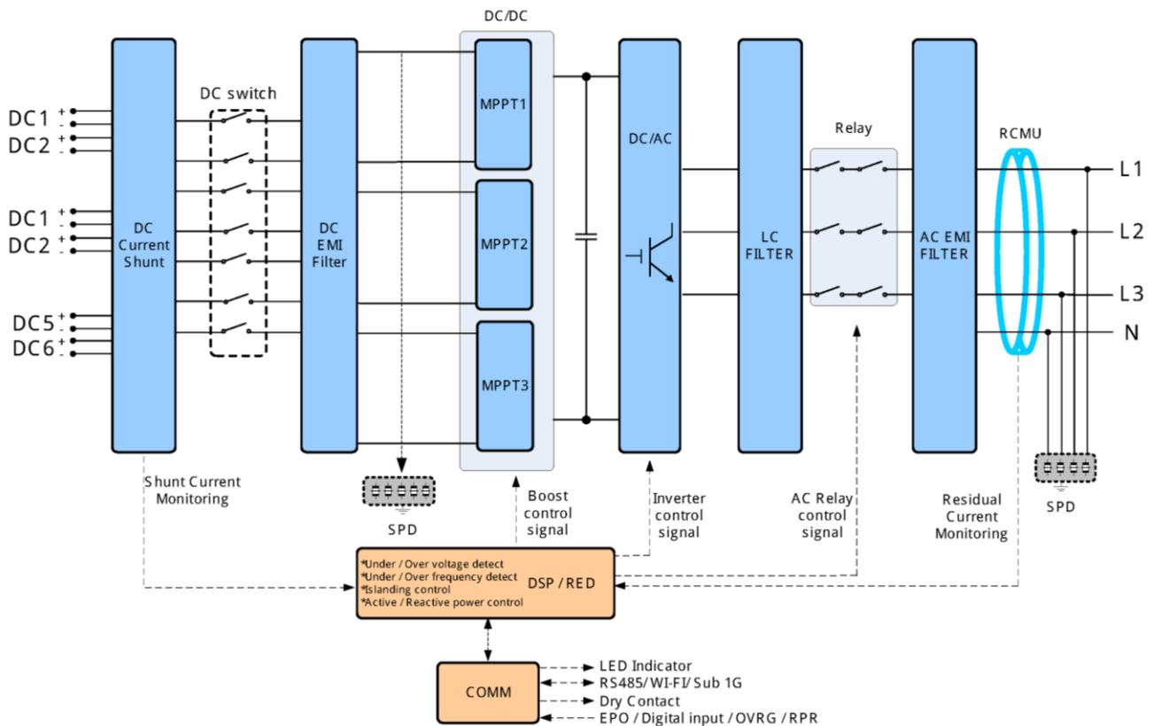
Der Wechselrichter bietet zur Kommunikation bzw. Fernüberwachung die Schnittstelle RS485. Über die Schnittstelle können Funktionen wie Wirkleistungsreduzierung und Blindleistungsregelung fernsteuerbar realisiert werden.
