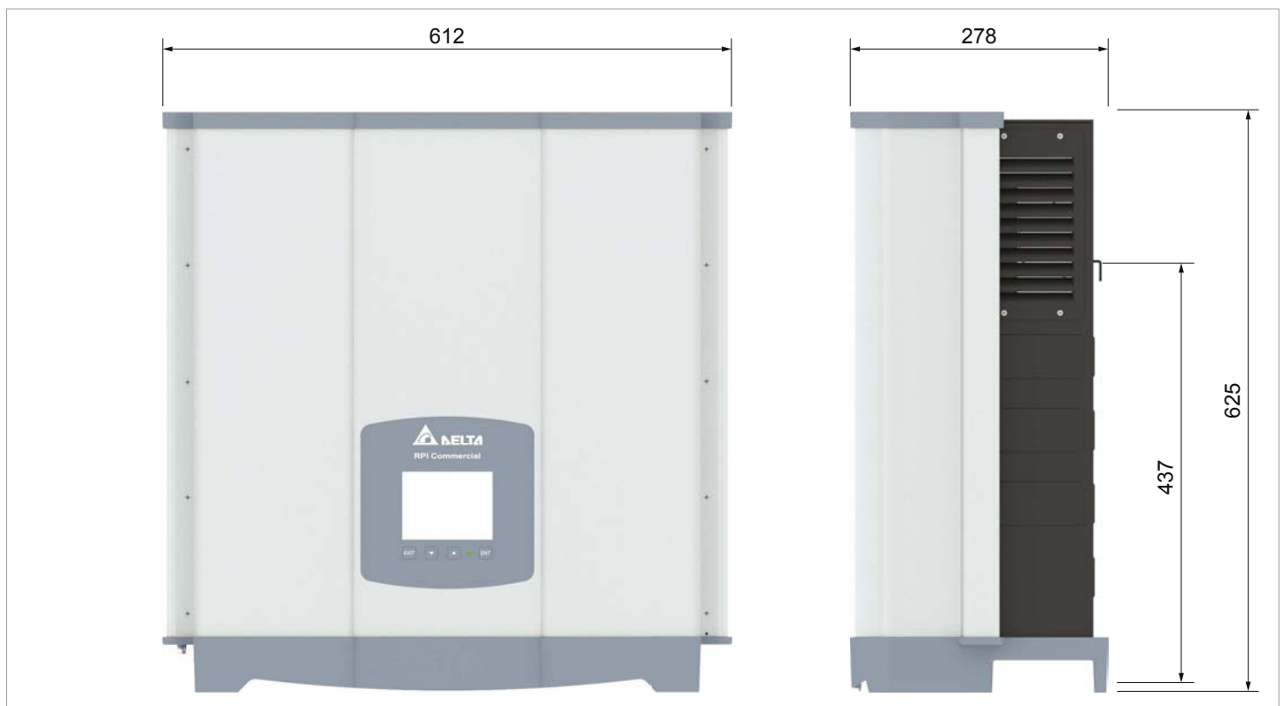
Fig. 6.9: Dimensions de l'onduleur (en mm)
