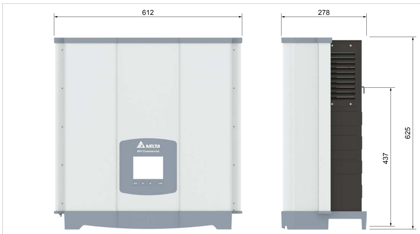
Afb. 6.9: Afmetingen omvormer (in mm)
