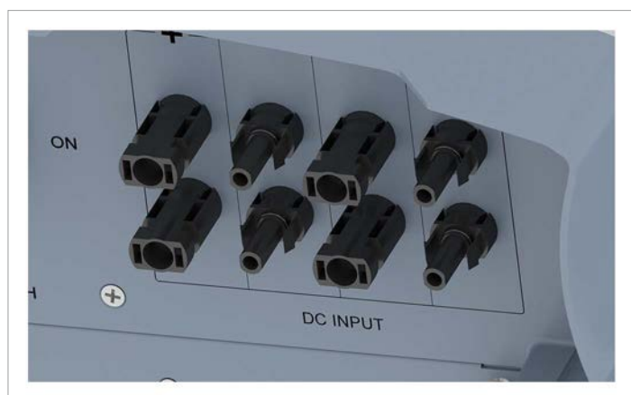
Ilustr. 4.7: Pozycja przyłączy prądu stałego na inwerterze
