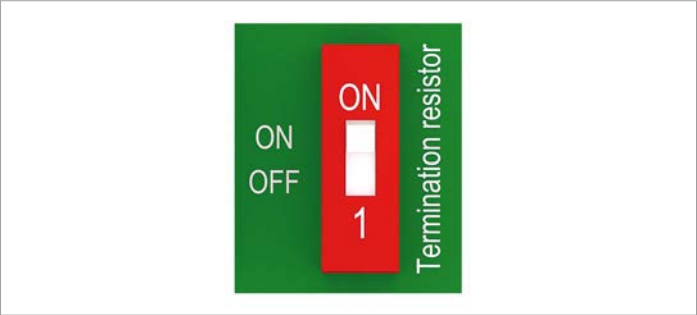
Fig. 6.26: DIP-omskifter til RS485-afslutningsmodstand
