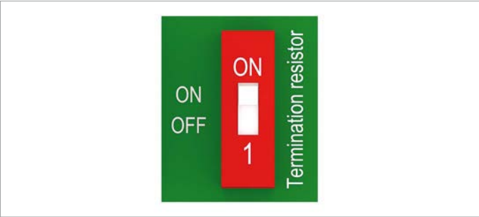
Fig. 6.26 : Commutateur de la résistance de terminaison RS485
