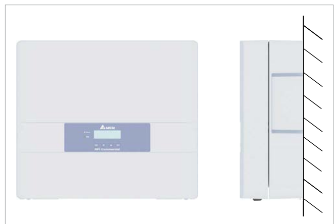
Fig. 5.3. : Orientation de montage
